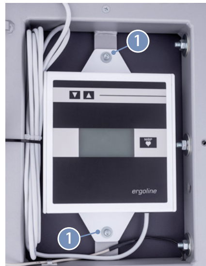
Abbildung 4 – 15: Bedieneinheit unter der Liegefläche
